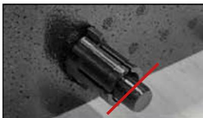
B) Conecte una de las salidas del tubo suministrado a la salida de condensados y el otro extremo al sifón, de manera que el sifón quede lo más vertical posible.
